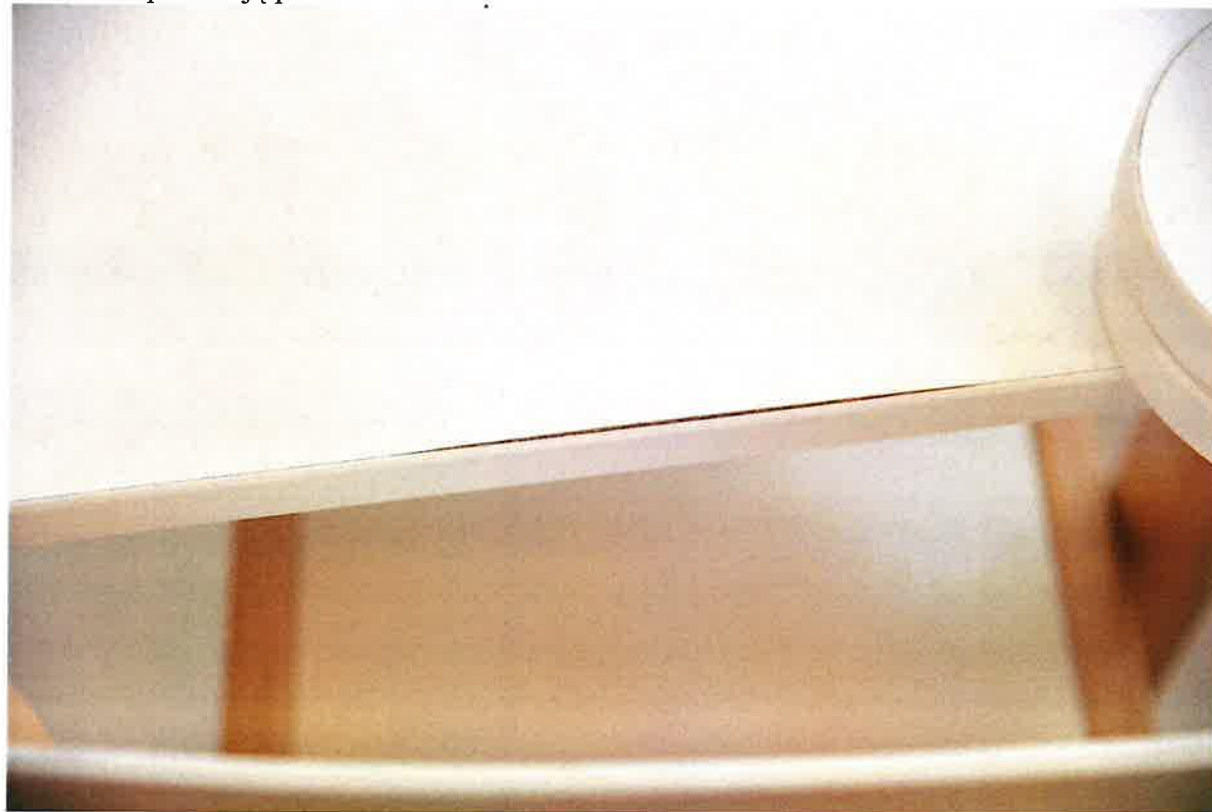
W niektórych stołach odchodzi okleina.
